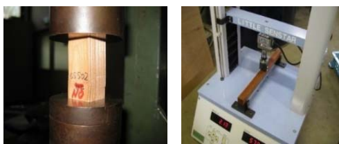
図3 強度測定 (圧縮：左、曲げ：右)
